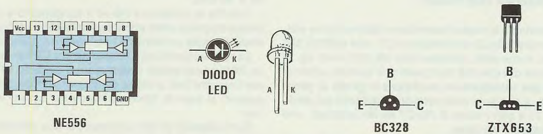
Fig.3 Connessioni dell'integrato viste da sopra e dei transistor viste invece da sotto.
